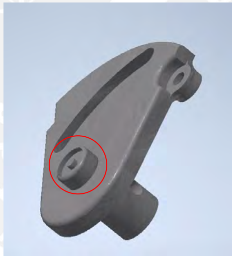
Figura 4.5. Disco de activación, En el círculo rojo se muestra las modificaciones del disco de activación para el ensamble del imán de neodimio
