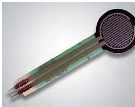
Figura 3.2. Sensor de fuerza FSR400 [Interlink, 2022].
