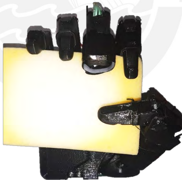
Figura 5.15. Prueba de control de posición-fuerza con diversos con una esponja
