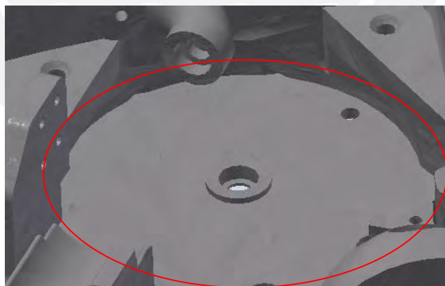
Figura 4.2. Adaptación de la palma, En el círculo rojo se observa las modificaciones de la palma para el ensamble del engranaje 46T
