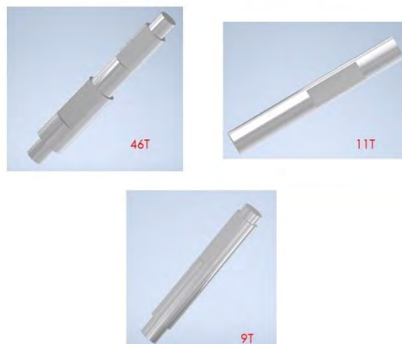
Modificación de ejes del sistema de transmisión de mecanizo
