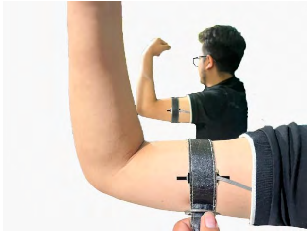
Figura 5.7. Posicionamiento de los sensores EMG en el bíceps del brazo
