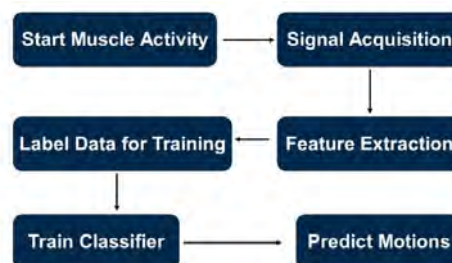
Figura 1.11. Diagrama de adquisición y procesamiento de señales EMG [Sattar et al., 2021].
