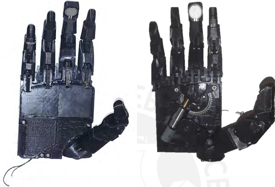
Figura 4.12. Mano protésica acoplada y sistema de transmisión de fuerza
