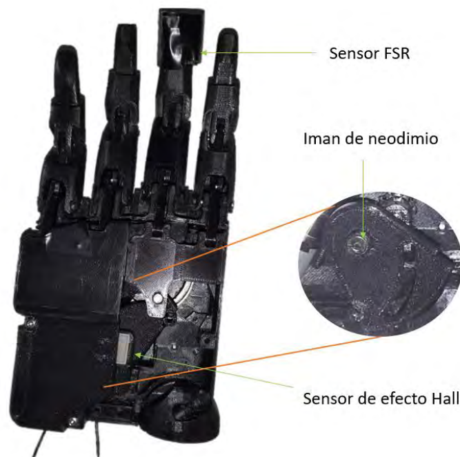
Figura 5.16. Instrumentación de la mano mioeléctrica
