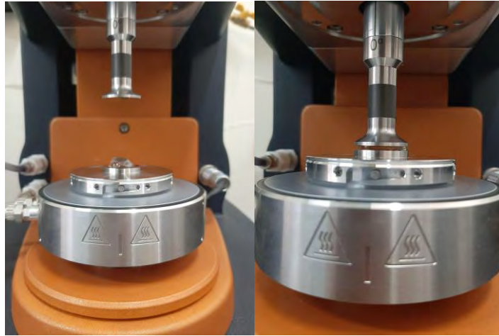
Figura 9. Muestra de hidrogel de carboximetilcelulosa al 15% w/v empleada en el estudio reológico y desarrollo del ensayo.
