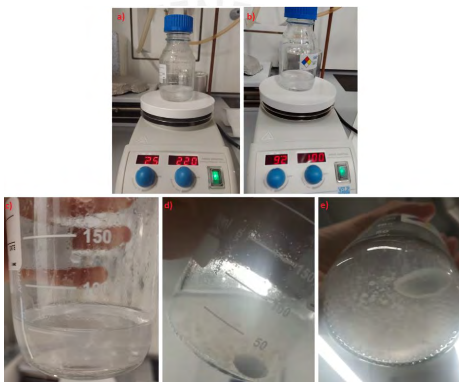
Figura 6. Disolución de colágeno: solución de ácido acético y colágeno en polvo sobre un agitador magnético con a) 25 °C y 220 revoluciones por minuto, b) 92 °C y 100 revoluciones por minuto; c-e) colágeno no disuelto después de 4 horas de agitación
