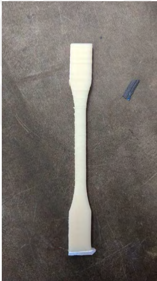
Figura 35. error en la fabricación de la probeta de PA/CF debido a soportes insuficientes y retracción inadecuada
