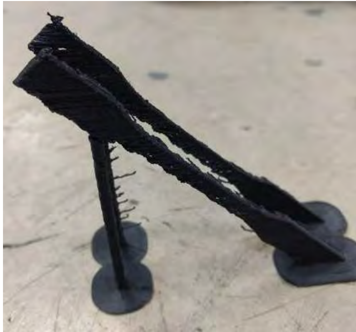
Figura 35. error en la fabricación de la probeta de PA/CF debido a soportes insuficientes y retracción inadecuada
