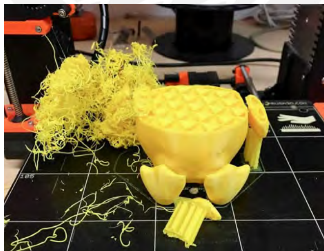
Figura 18. Error de calibración [Pick 3D Printer, 2020].
