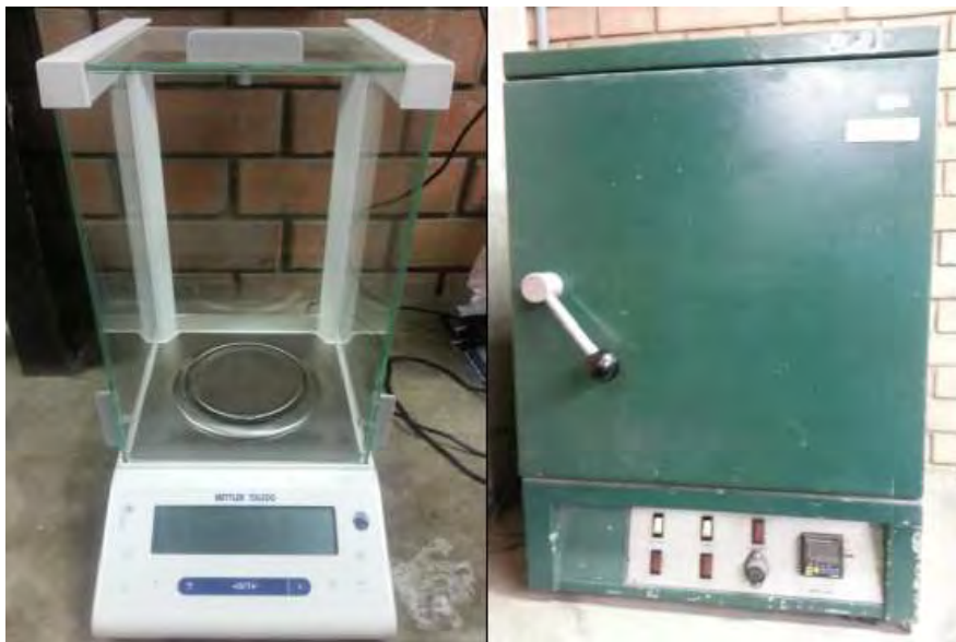
Figura 25. Horno de convección forzada (lado derecho) y balanza analítica (lado izquierdo).
