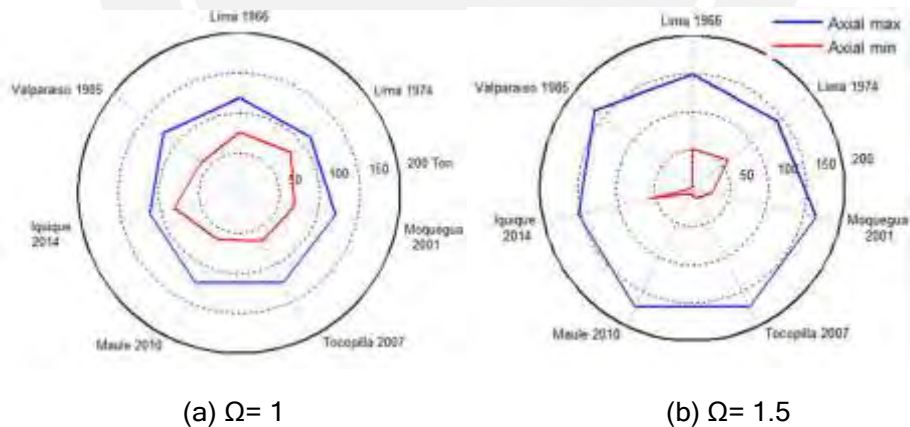
Figura 5.6: Fuerza axiales máximas y mínimas por registros sísmico del aislador ubicado en la esquina inferior derecha correspondiente a casos con T_y=0.7 s, T_y/T_x=0.75 , e_r/r=0 , T_b=3 s, \xi_b=10\%
