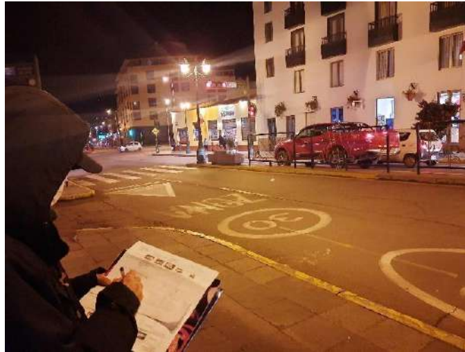
Figura 5. Conteo de vehículos por métodos manuales realizado en la avenida El Sol, Cusco. Fuente: propia.
