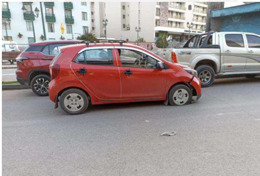
Figura 9. Vehículos con parachoques delantero descuadrado y llanta dañada. Fuente: propia.
