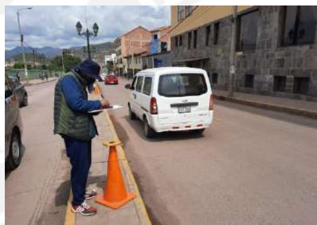
Foto 28: Medición del tiempo de viaje de los autos del punto 1 al punto 2.
