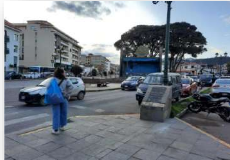
Foto 74: Visibilidad peatonal reducida por la zona de estacionamiento en la mediana, avenida Tullumayo.
