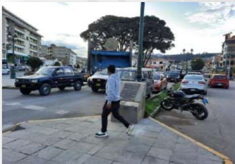
Foto 75: Visibilidad peatonal reducida por la zona de estacionamiento en la mediana, avenida Tullumayo.
