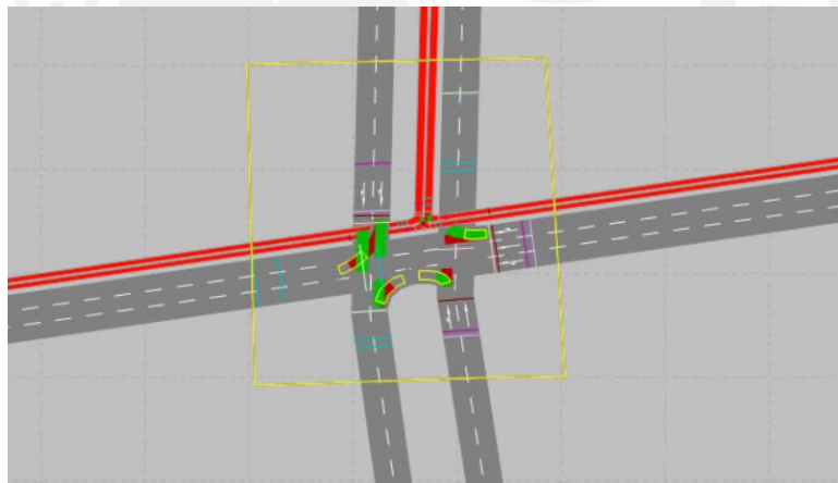
Figura 58. Modelo de microsimulación de propuesta en PTV Vissim. Fuente: PTV Vissim.
