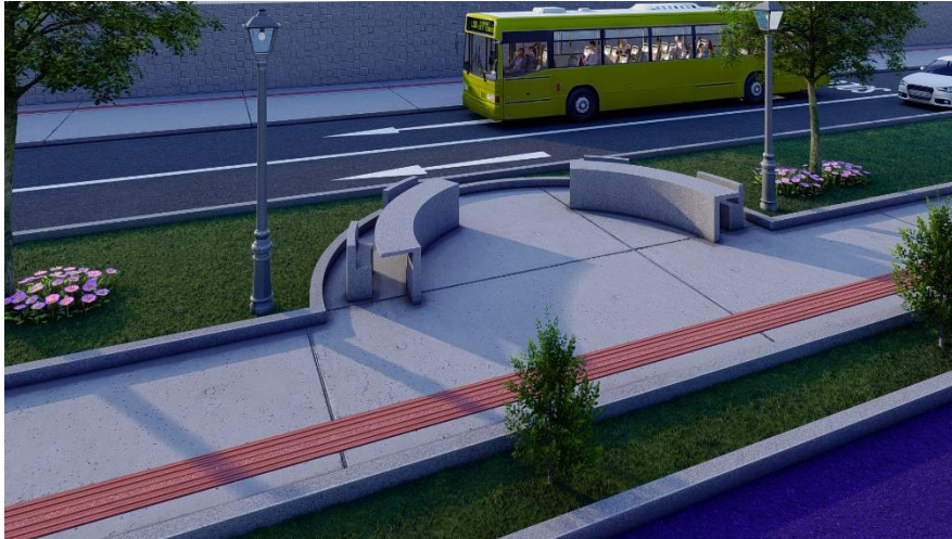
Figura 37. Ruta de baldosas podotáctiles. Fuente: Tomada de (Noticias, 2022)
