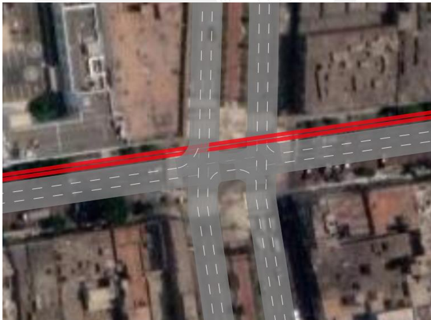
Figura 50. Modelo base de Av. 2 de Mayo con Av. Sáenz Peña en PTV Vissim. Fuente: Elaboración propia en PTV Vissim.
