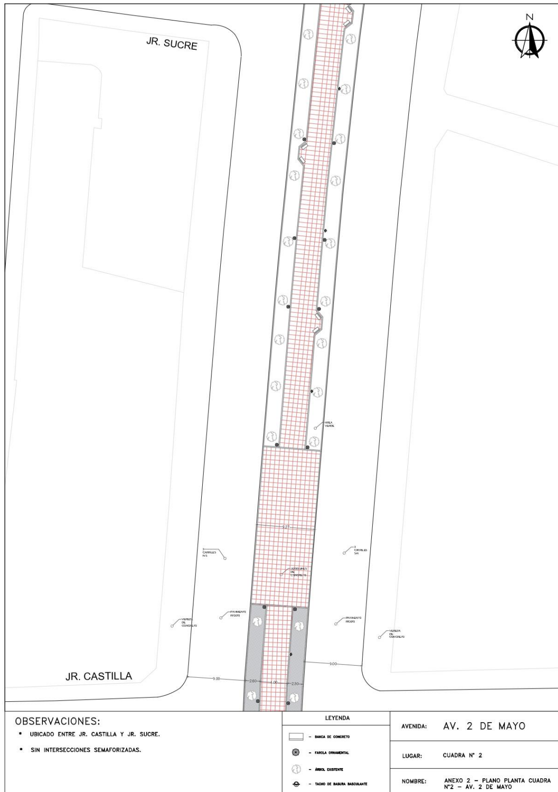
Figura 2. Plano de planta de estado actual de la Av. 2 de Mayo en la cuadra N°2. Fuente: Elaboración propia
