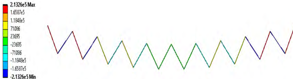
Figura C-8. Fuerzas axiales internas sobre las diagonales (Valor Máx.: ±47.94 kips).
