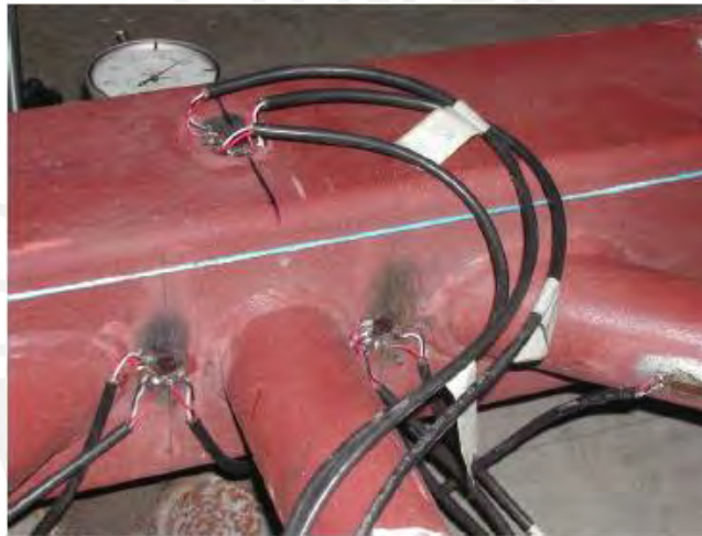
Figura 3-24. Disposición de las galgas de medición. Imagen obtenida de (Oliveira Mendanha, 2006).
