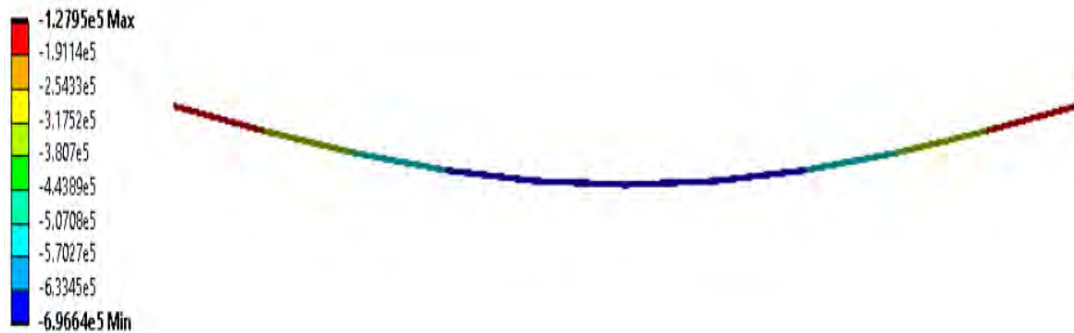
Figura C-4. Fuerzas axiales internas sobre la brida superior (Valor Máx.: 156.61 kips). Fuente propia.
