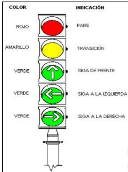
Figura 10. Indicación de los colores de los lentes de un semáforo.
