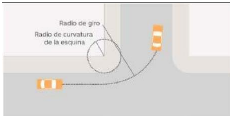
Figura 9 Radio de giro en una intersección
