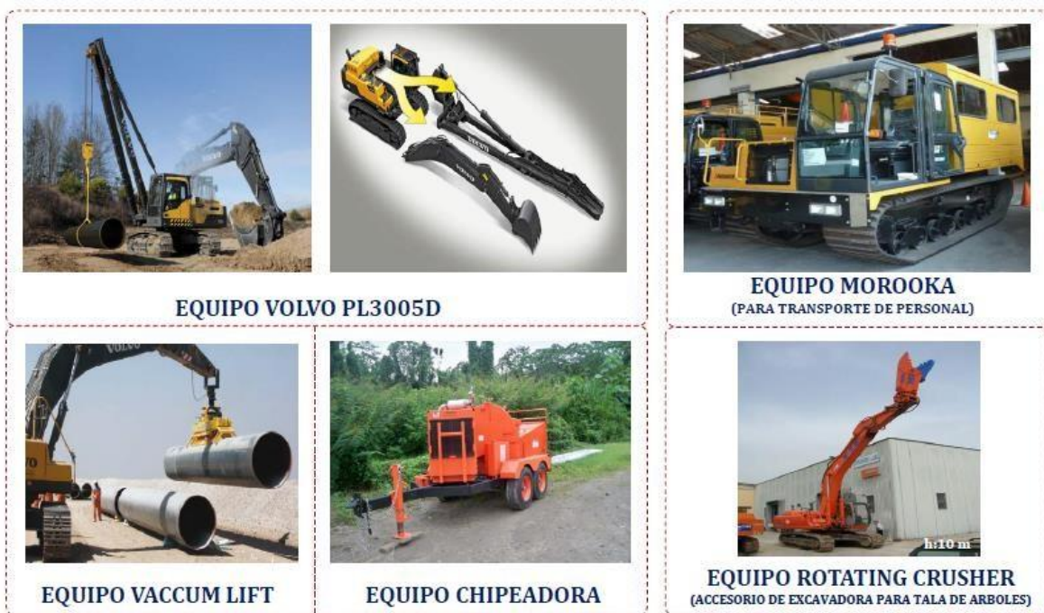
Figura 11: Maquinaria utilizada en el proyecto EPC Flowline entre Cashiriari 1 – Malvinas
