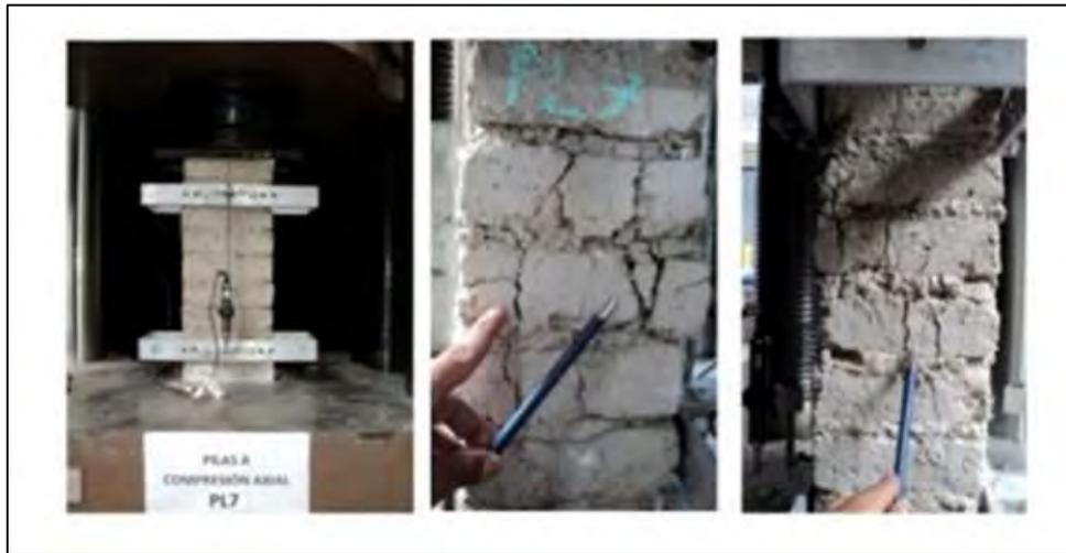
*Figura 26. Ensayo de pila y falla del espécimen*
