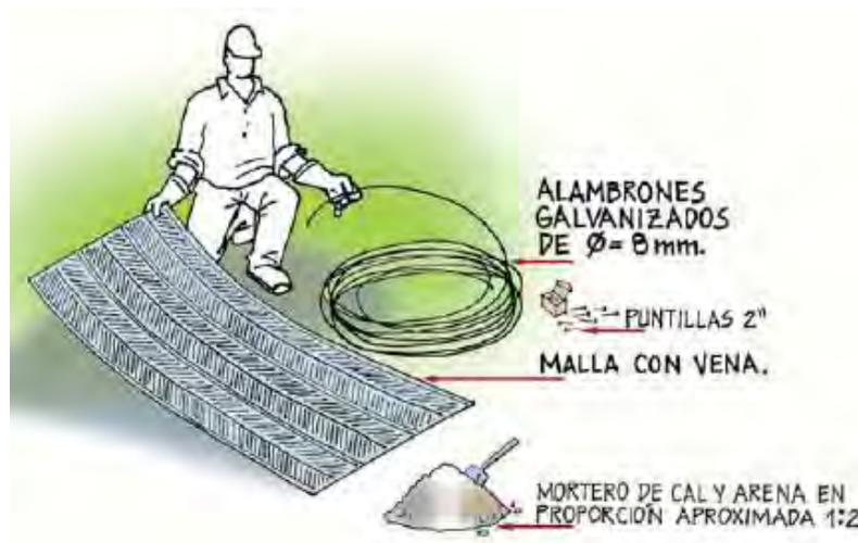
Figura 45. Materiales empleados en el refuerzo de muros con mallas de acero y mortero
