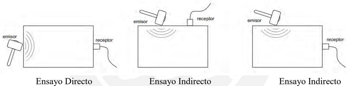
Figura 40. Diferentes configuraciones para el ensayo de pulso sónico
