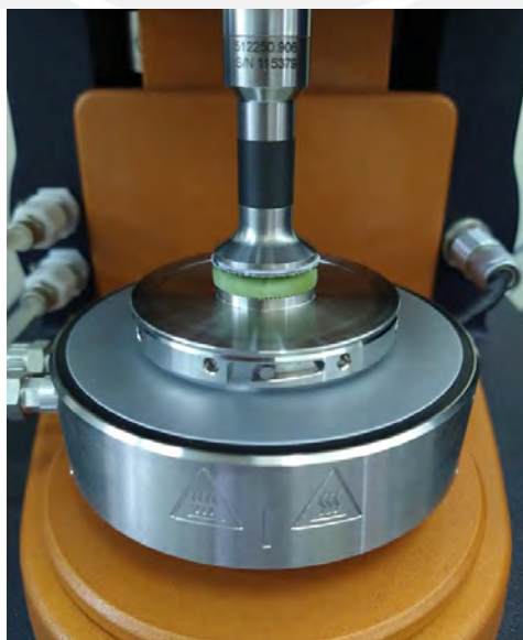
Figura 21. Reómetro Discovery HR1 durante el ensayo.
