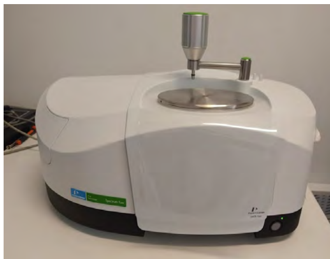
Figura 20. Espectrómetro FTIR Perkin Elmer Spectrum Two con accesorio ATR utilizado en los ensayos.
