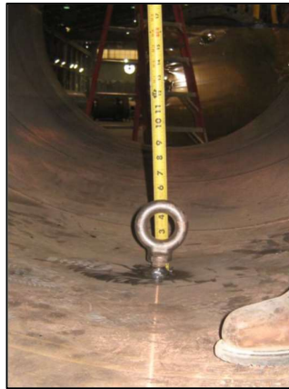
Figura 4-5: Gancho prefabricado para instalación de medidores de convergencia “convergence meter”, (SHARMA, 2013).
