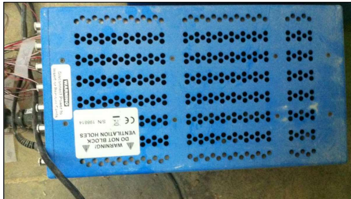
Figura 4-10: Scanner Sistema 7000 usado en las pruebas, (SHARMA, 2013).
