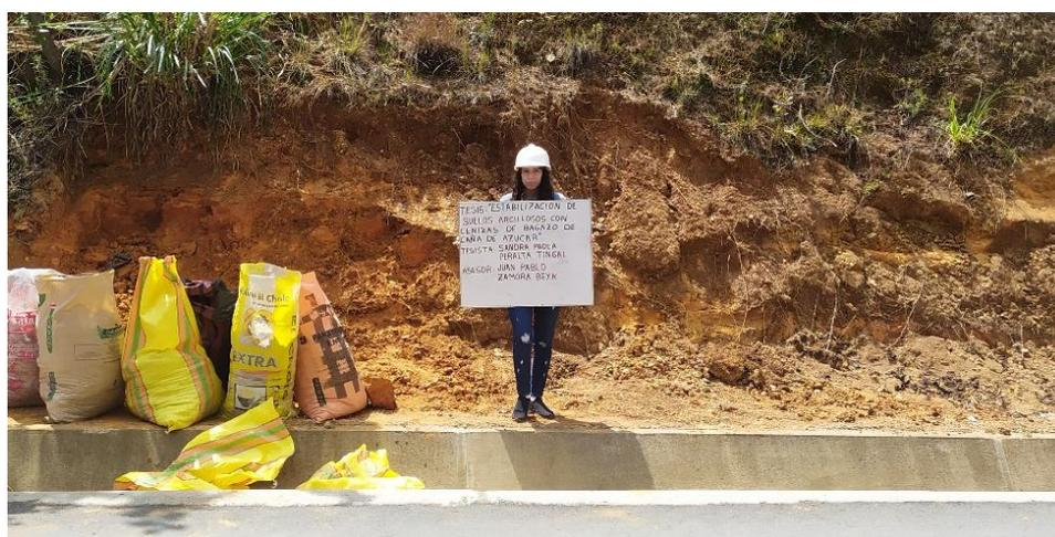
Figura 6. Extracción de muestras de arcilla.
