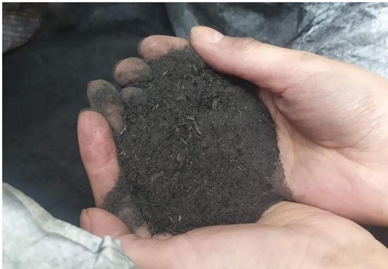
Figura 8. Muestras de cenizas de bagazo.
