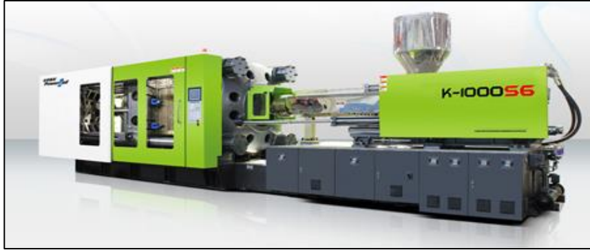
Figura 15: Máquina inyectora de plástico Fuente: Powerjet (2016)
