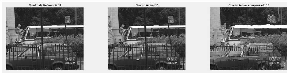
Fig. 26: Estimación de Movimiento Entera del cuadro 15 con respecto al cuadro 14 y el cuadro 15 compensado para la secuencia Bus .
