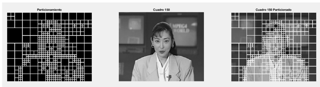
Fig. 21: Particionamiento para el frame 150 de la secuencia Akiyo .
