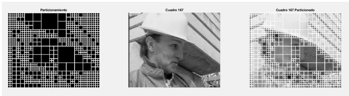
Fig. 41: Particionamiento del cuadro 167 de la secuencia de video Foreman .
