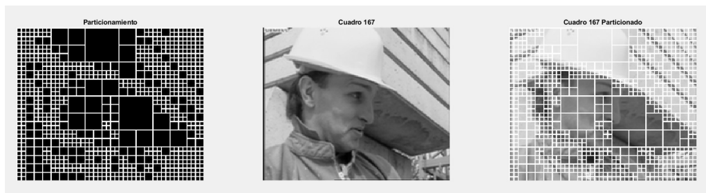
Fig. 22: Particionamiento para el frame 167 de la secuencia Foreman .
