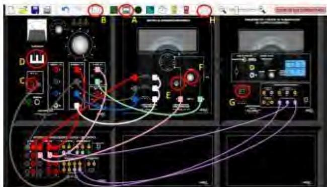
Figura 28 - Conexión para el ensayo con carga
