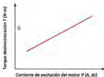
Fig. 10 Resultado esperado - Corriente de excitación vs Torque de sincronizador
