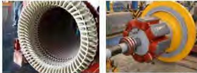
Fig. 2 Estator y rotor de polos salientes de un Motor Sincrono trifásico de campo giratorio.
