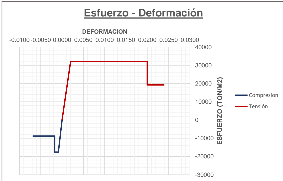
Figura 8.13. Curva esfuerzo-deformación utilizada para los arriostramientos ASTM A500 0.30 m x 0.30 m
