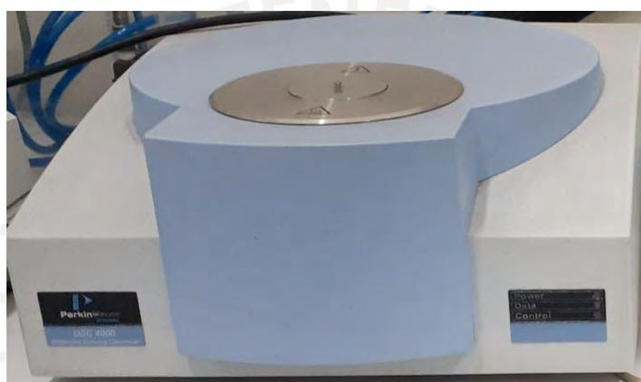
Figura 31 Calorímetro diferencial de barrido, modelo DSC 4000 de la marca Perkin Elmer
