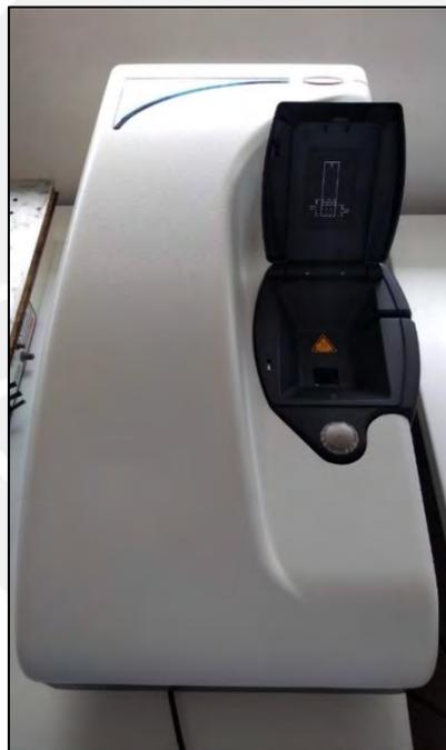
*Figura 28 Analizador de tamaño de partículas NanoS90 mediante dispersión dinámica de luz (DLS)*
