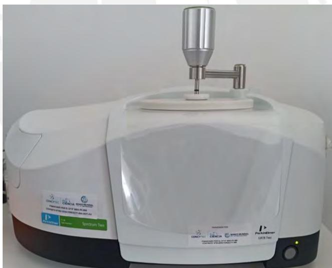
Figura 33 Accesorio ATR acoplado al equipo FTIR, modelo Spectrum Two de la marca Perkin Elmer.
