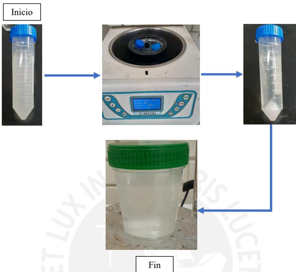
Figura 21 Esquema representativo del lavado de nanopartículas de almidón
