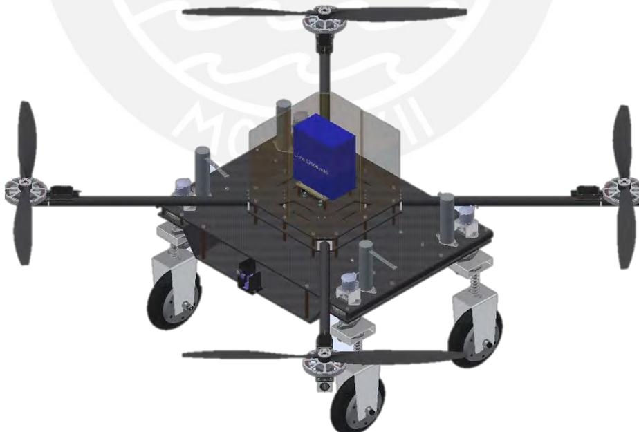
Figura 3.34: Módulo terrestre y aéreo acoplados.
