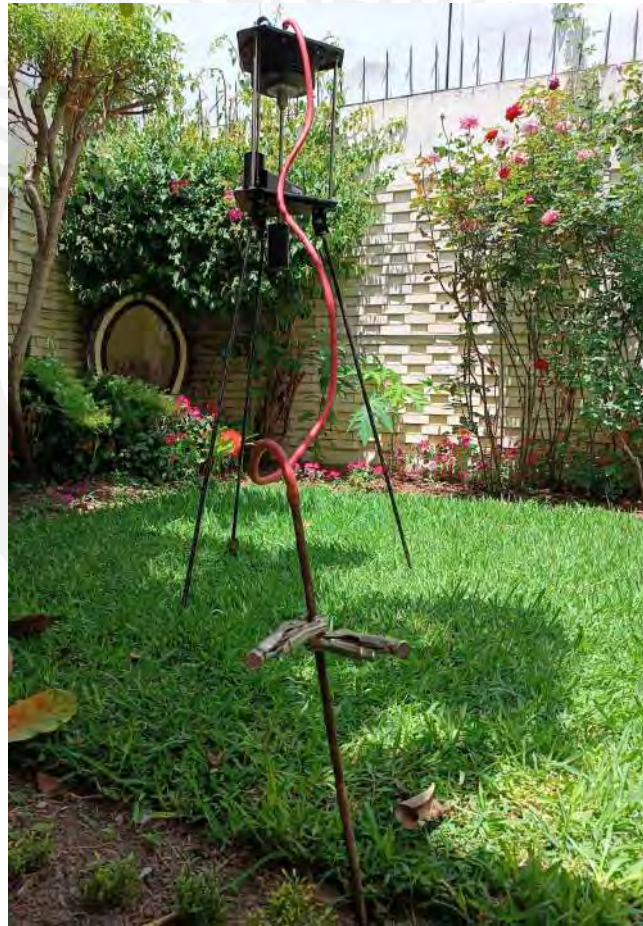
Figura 3.1: Medición de permeabilidad en viviendas empleando el Radon-Jok
