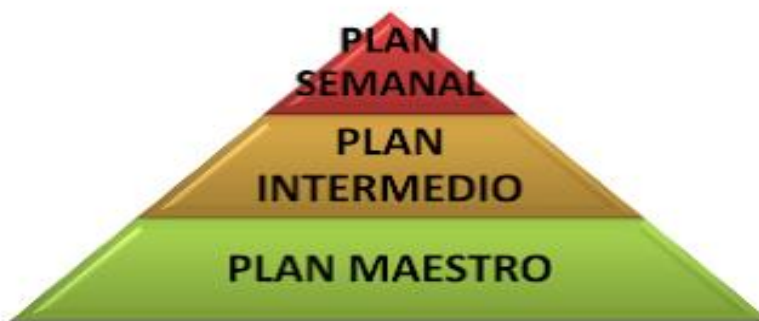
Figura 7.2: Pirámide de Planificación (Lean construction Enterprise, 2012)
