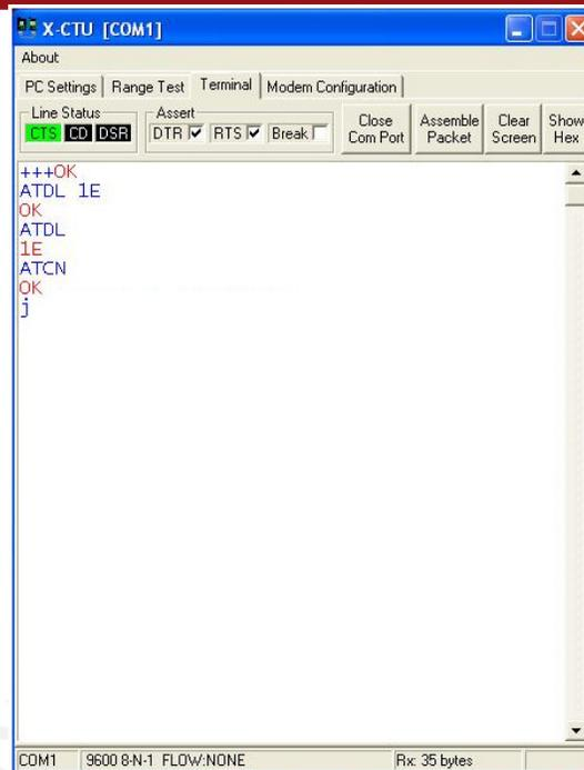
Fig. N°43 Envío de carácter ASCII con la información de la dirección en entorno X-CTU dato recibido por microcontrolador.
