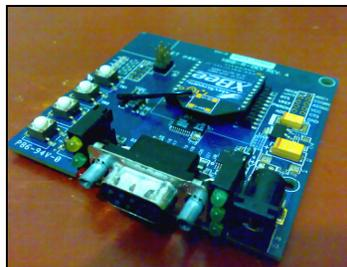
Fig N°25. Tarjeta de Interfase Xbee – PC con salida serial.
