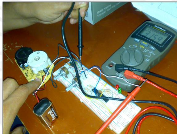
Fig. N°34. Pruebas de salida del amplificador operacional en estado de detección con pulsador de testeo
