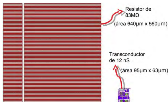
Figura 1.6: Diferencia de dimensión de una resistencia y una transconductancia [6].
