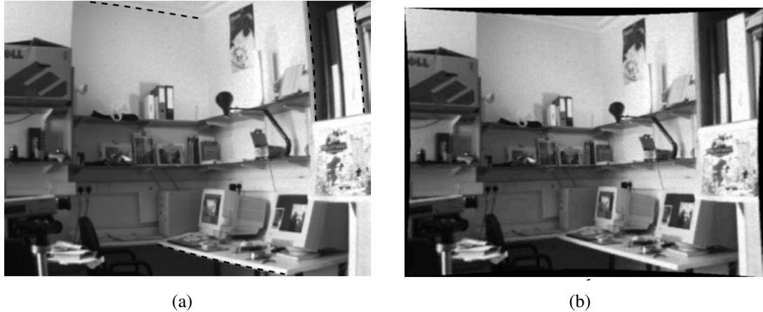
Figura 2.5: Calibración y corrección de distorsión de una cámara: En (a) se observa una imagen original capturada por una cámara, en líneas discontinuas se resalta la distorsión de las rectas; En (b) se presenta la imagen sin distorsión, luego de rectificarla empleando los coeficientes de distorsión. Imágenes tomadas de [23]
