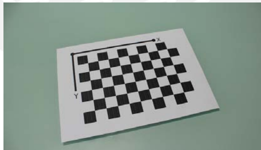
Figura 2.4: Imagen de un tablero de ajedrez, empleada durante el proceso de calibración de la cámara. Elaboración propia.
