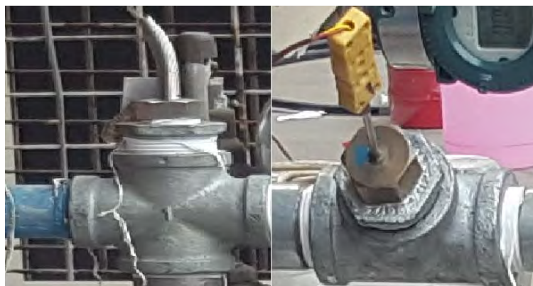
Figura 2.12 – Sensor de temperatura instalado al tanque de aire comprimido (izq.) y sensor instalado en la línea de pruebas (der.).
