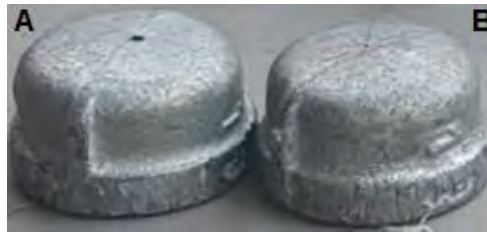
Figura 2.10. Tapón maquinado de 3 mm (A) y de 1 mm (B).
