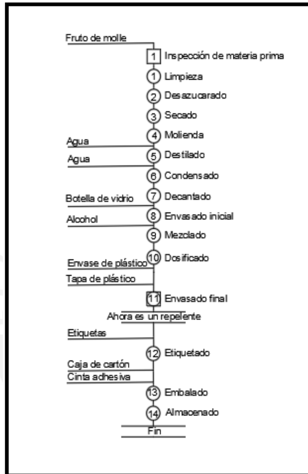
Figura 18. Diagrama de operaciones del proceso Fuente: (Cárdenas E., 2014)
