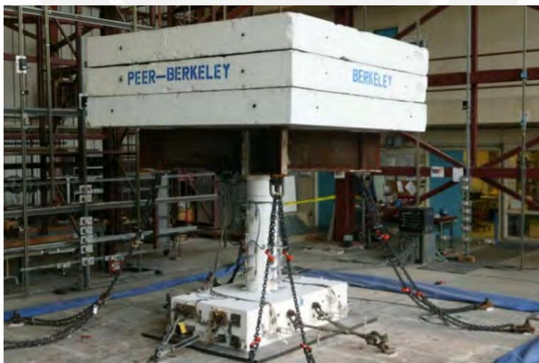
Figura 2.3: Aplicación de columna basculante como pilar para puente (Espinoza et al., 2006)
