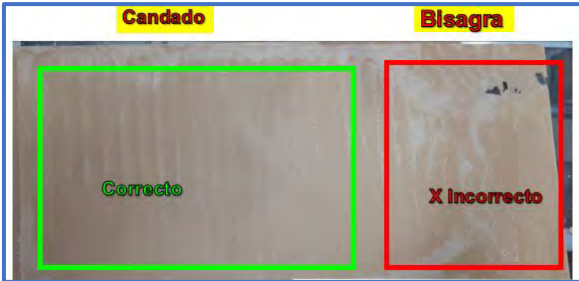
Figura 104 Defecto de dosificado y hueco en oblea
