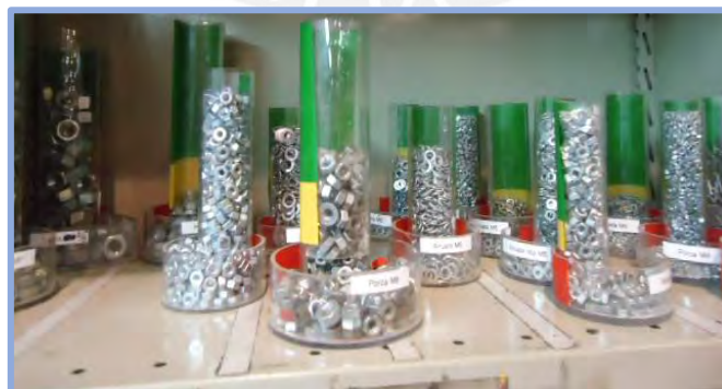
Figura 86 Control visual semáforo
