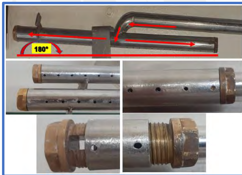
Figura 105 Defecto en flauta de dosificado
