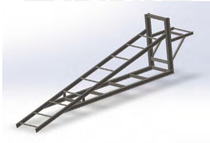
**Figura 2.15** Esquema de estructura sin arriostre de refuerzo (Elaboración propia)
