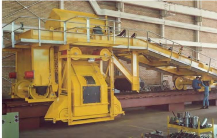
*Figura 2.1 – Estructura Tripper sin arriostre de reforzamiento*
