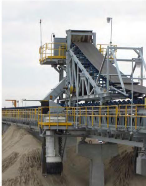
*Figura 2.2 – Estructura Tripper con arriostre de reforzamiento*
