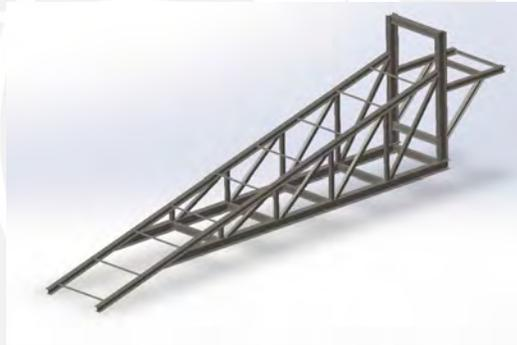
**Figura 2.29** Estructura Trippler con Arriostre Inferior (Elaboración propia)
