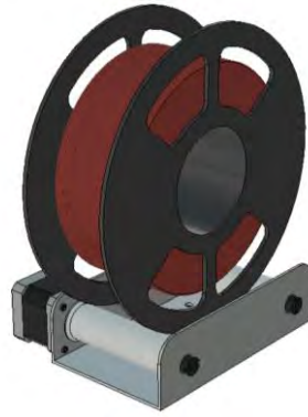
Figura 6.1: Sistema motriz del filamento 3D
