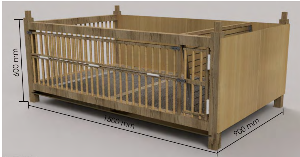
Figura 39: Render digital de la propuesta elegida con las medidas
