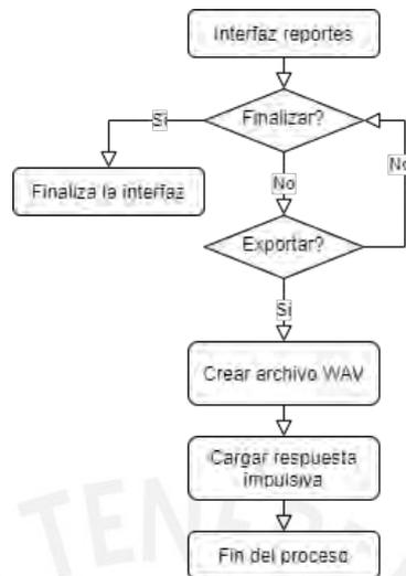
Figura 5.9. Diagrama de flujo del proceso de exportación de la respuesta impulsiva a un archivo WAV.
