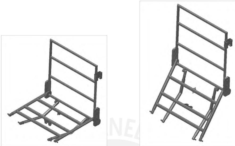
Fig. 2.16: Sistema de movimiento para lograr el bipedismo de la silla en la posición sentada (izquierda) y bípeda (derecha).
