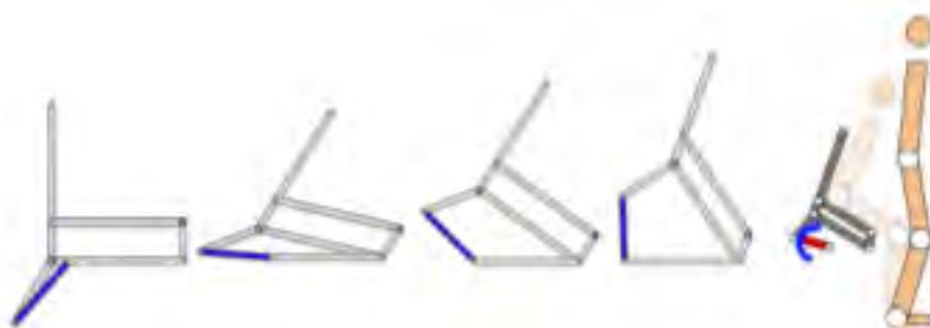
Fig. 1.12: Funcionamiento del mecanismo de ayuda para la posición bípeda. [Jiang, 2019]
