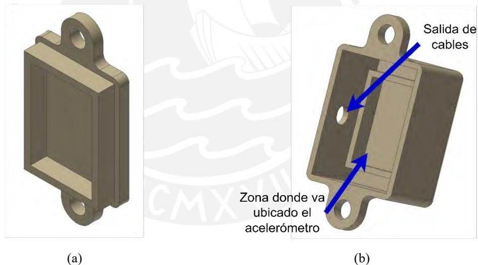
Fig. 3.5: Tapa del contenedor del acelerómetro (a) y contenedor del acelerómetro (b).
