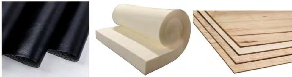
Fig. 4.7: Cuero sintético, cojín de tapicería y tablas de maderas para la fabricación del respaldar y asiento<sup>13</sup>.
