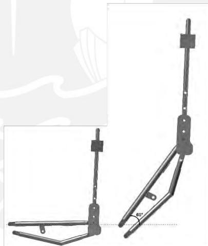
Fig. 2.17: Posición sentada y bípeda del sistema móvil de la silla en vista lateral.
