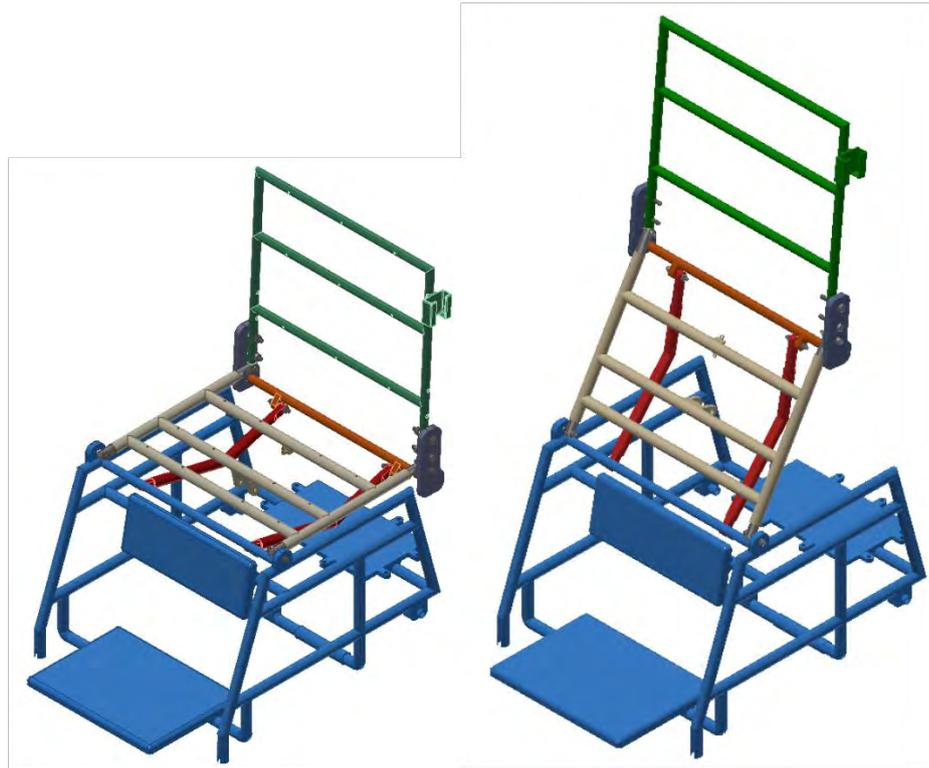
Fig. 2.19: Vista isométrica del diseño mecánico principal de la silla de ruedas en posición sentada y bípeda.
