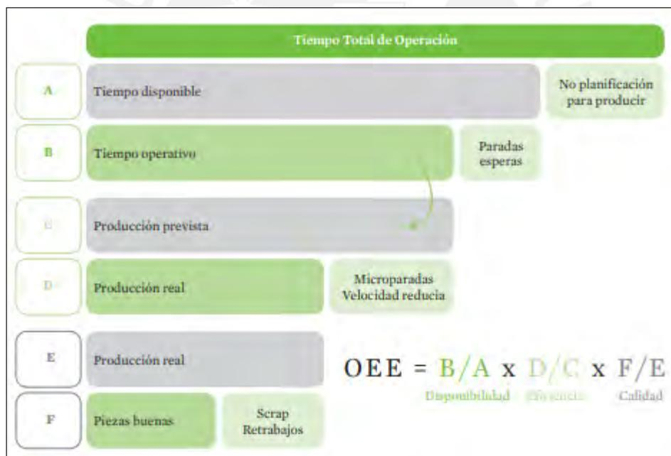
Figura 6. Esquema de los componentes del OEE
