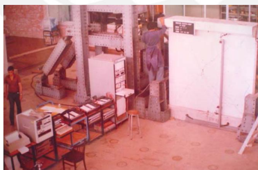
Figura 2.1: Vista global de los dispositivos empleados en el ensayo de un muro (San Bartolomé, 1983).
