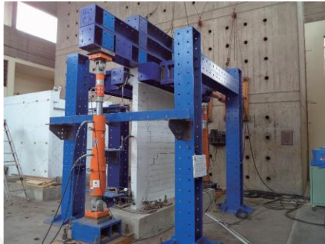
Figura 2.10: Muro de ladrillo pandereta ensayado (Zavala et al., 2014).
