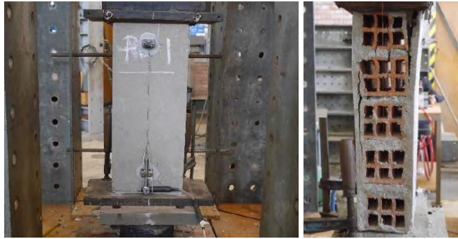
Figura 2.16: Pila reforzada con malla electrosoldada (Bazalar & Espinoza, 2021).
