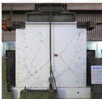
Figura 2.7: Falla final de un muro con carga axial (Pari & Manchego, 2017).
