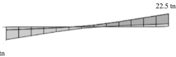
Figura 5.6.13 Diagrama fuerza cortante última (Vu) viga V-6 tramo 1
