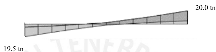
Figura 5.6.15 Diagrama fuerza cortante última ( V_u ) viga V-6 tramo 3
