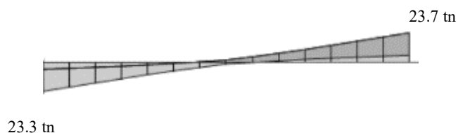
Figura 5.6.14 Diagrama fuerza cortante última ( V_u ) viga V-6 tramo 2
