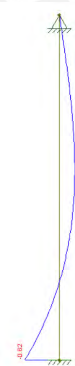
Figura 63. DMF de muro pantalla
