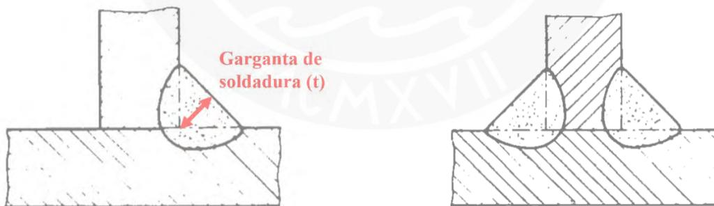
**Figura 1.8** Junta en T. (a) Simple, (b) Doble (Adaptado de DIN 1912, 1976)
