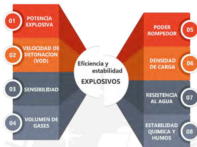
Gráfica N°6: Parámetros a evaluar para comparar eficiencia y estabilidad de explosivos
