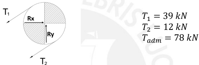
Figura 1.7 Diagrama de tensiones actuantes en el tambor motriz.
