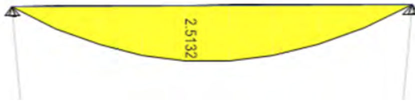
Figura 22: Diagrama de momento flector de la viga chata VC-A. (ton.m)
