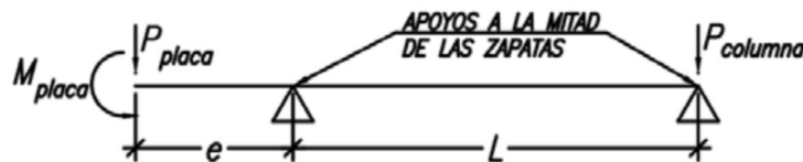
Figura 55: Modelo considerado para el diseño de la viga de cimentación (Higashi, 2020)
