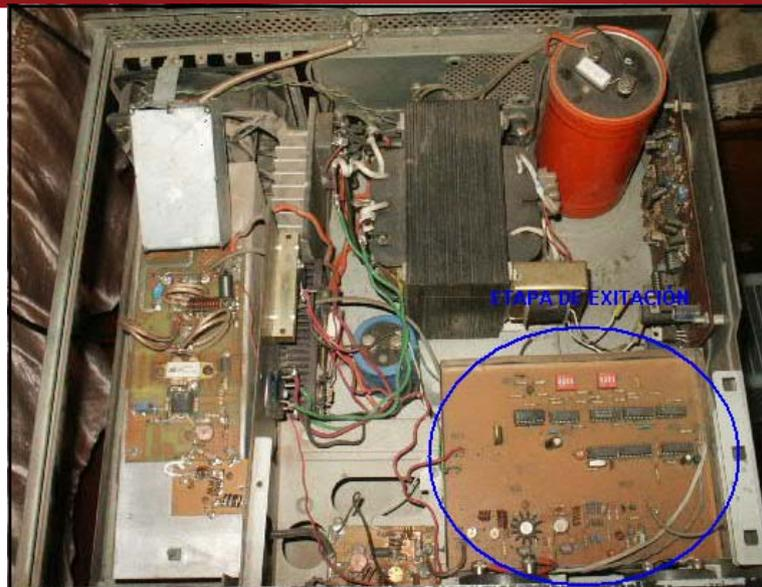
Figura 2.4 Excitador / Transmisor de Frecuencia – vista interna
