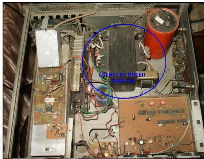
Figura 2.7 Fuente de poder en un transmisor integrado
