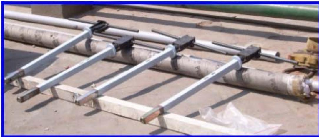
Figura 2.10 Antena Dipolo de polarización vertical
