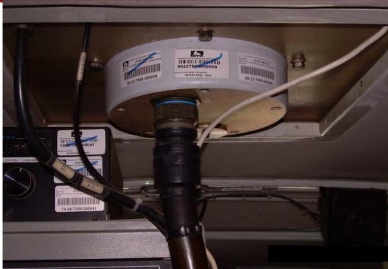
Figura 4.8 Unidad de Conmutación de antenas AEA 192
