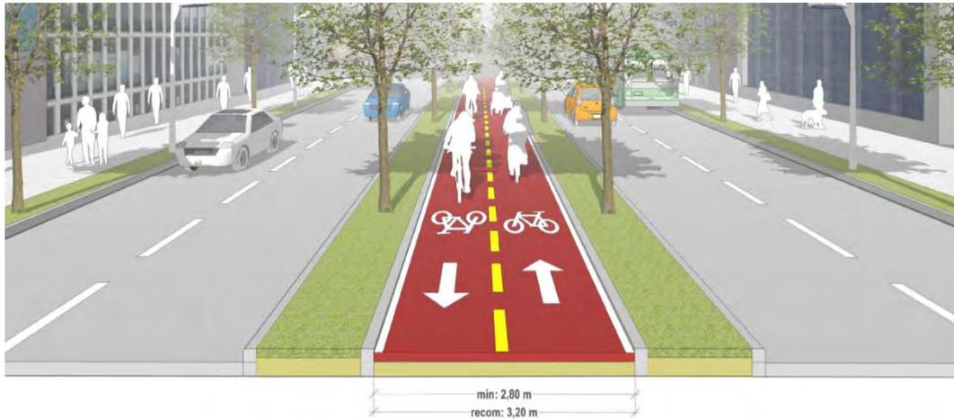
**Figura 9:** Diseño de una vía arterial con ciclovía central.
