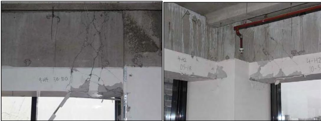
*Figura 2.25 Formación de rótulas plásticas del pórtico prefabricado (Fleischman et al. 2014)*
