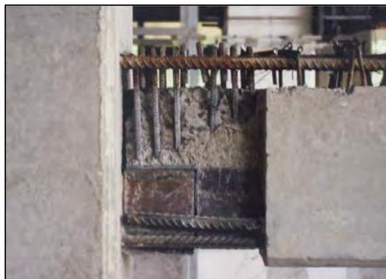
*Figura 2.9 Conexión típica de especímenes (Rodríguez, 2001)*
