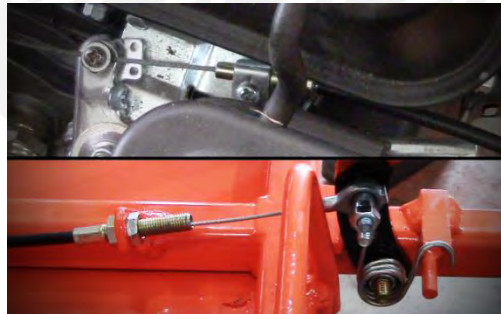
Figura 2.29: Sistema de aceleración de un kart
