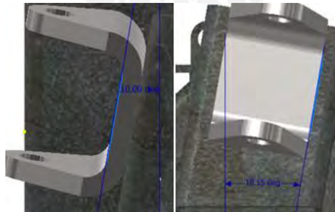
Figura 4.4: Ángulos de ubicación del soporte del eje de dirección.
