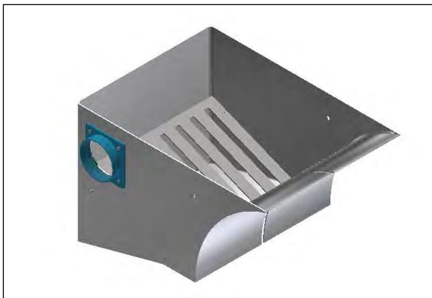
Figura 5.1 Diseño óptimo de la tolva. Fuente: Elaboración propia.
