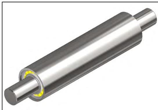
Figura 6.21 Modelo CAD del rodillo de reenvío. Fuente: Elaboración propia.
