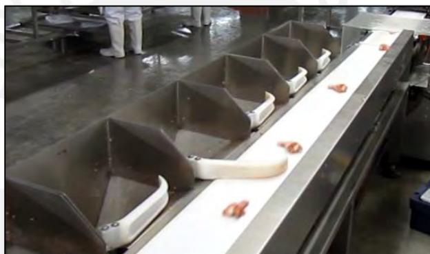
Figura 2.8 Máquina clasificadora automática<sup>11</sup>
