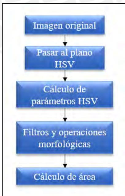
Figura 7.1 Diagrama de flujo del algoritmo. Fuente: Elaboración propia.
