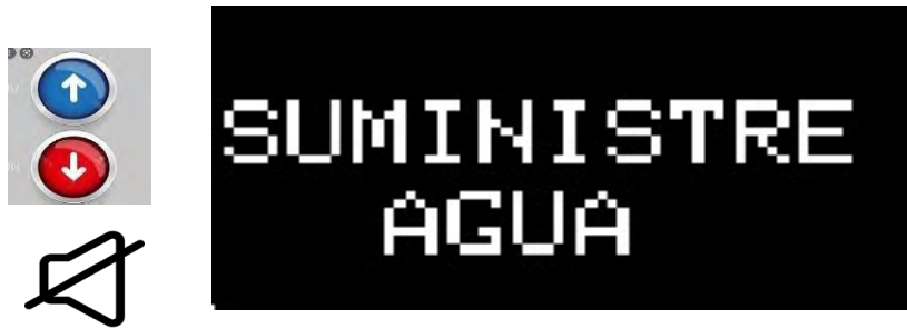
Figura 46. Mensaje de alerta del dispositivo humidificador calentador de aire mezclado con oxígeno (HYCAO)
