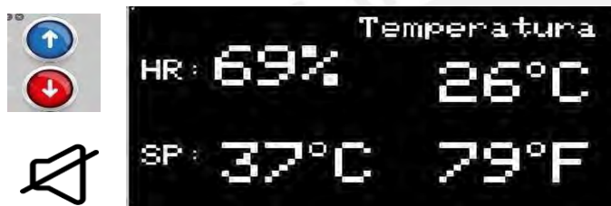
Figura 44. Pantalla principal del dispositivo humidificador calentador de aire mezclado con oxígeno (HYCAO)
