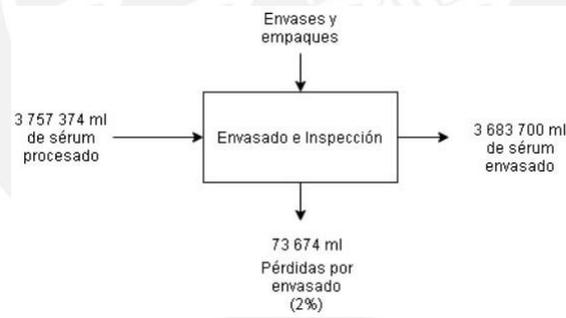
*Figura 24:* Balance de masa en Envasado e Inspección
