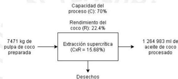
*Figura 27:* Balance de masa en Extracción supercrítica de aceite coco
