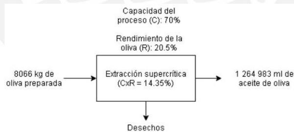
*Figura 28:* Balance de masa en Extracción supercrítica de aceite de oliva
