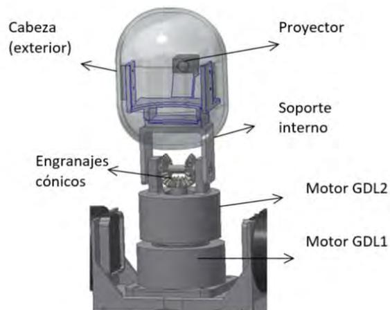
Figura C.8: Concepto solución 3 – Detalle subsistema cabeza. Elaboración propia.
