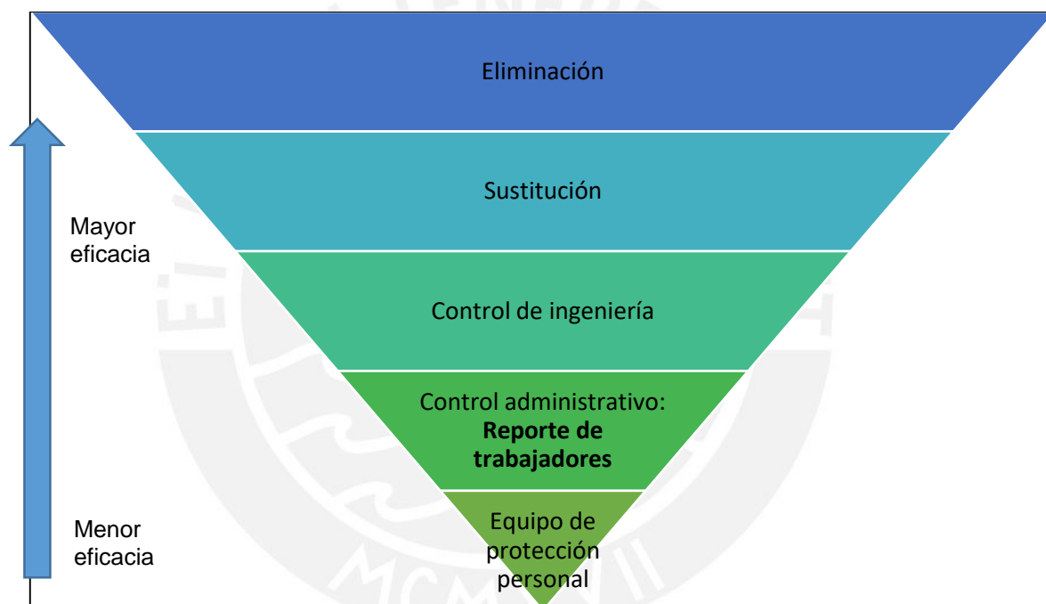
Ilustración 14: Ubicación del reporte de trabajadores en el pirámide de jerarquía de controles
